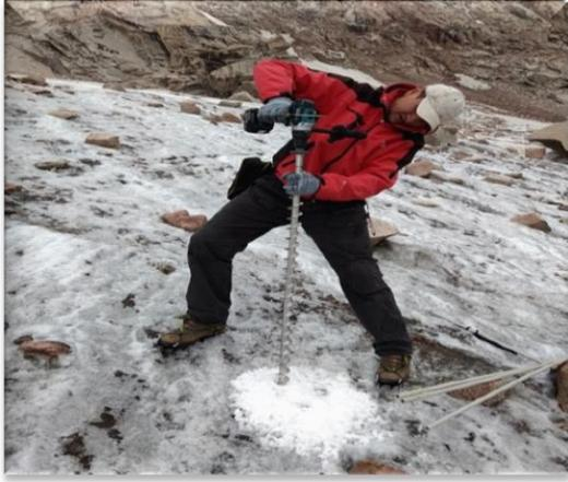
Рис. 11: Установка абляционных реек
